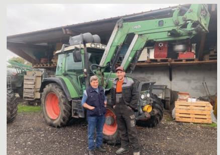
**L'essai de conversion dual fuel est mené sur un Fendt 310 Vario embarquant deux boîtes de 90 litres de biométhane.**
