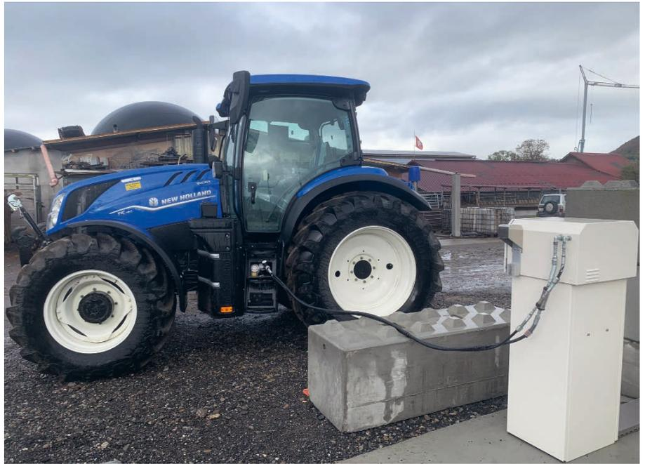
**Le plein de ce tracteur «T6.180 Methane Power» de New Holland carburant à 100% au biométhane est opéré en quelques minutes comme pour un tracteur à moteur diesel.**
